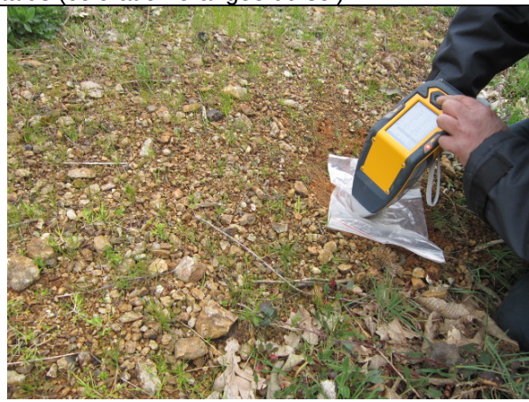
A gauche : résidu minier supposé (granulométrie décimétrique) A droite : mesures NITON sur talus (végétation éparse)
