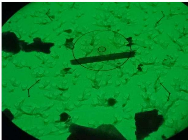
**Photo 7 : Particule allongée de chimie proche de la trémolite et d'actinote, vue en META**
