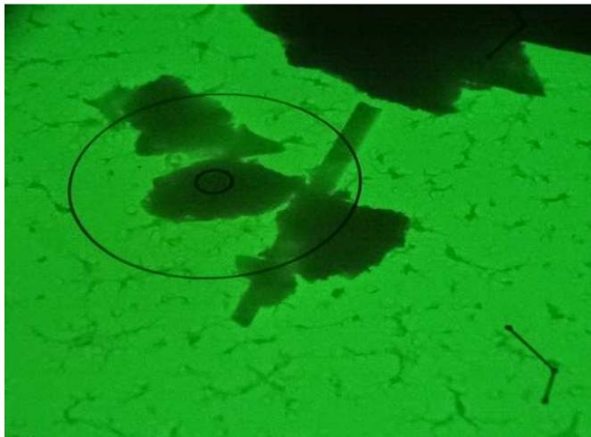
Photo 2 : Particule allongée de chimie proche de la trémolite et d'actinote, vue en META (Grand cercle 2.96μm, petit cercle 0.37μm)
