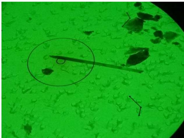
**Photo 2 : Particule allongée de chimie proche de la trémolite et d'actinote, vue en META**
