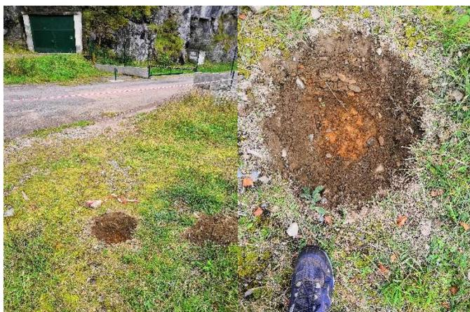
Figure 4 : Avant trou du sondage 5 : pas de film d'étanchéité observé au-dessus des résidus oxydés
