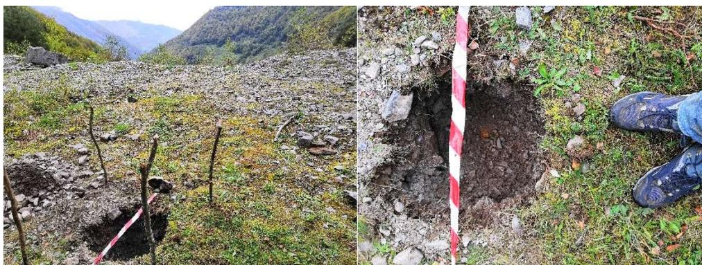
Figure 3 : Avant trou du sondage 4, pas de film d'étanchéité observé.
